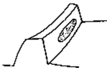
**Рис. 5-8 Отпечаток контакта зубчатого зацепления.**
