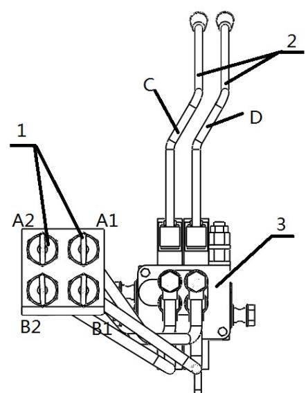
При работе соедините устройство с наружной резьбой и адаптер с внутренней резьбой, соедините с выпуском гидравлического цилиндра сельскохозяйственной технике регулировочная ручка D, контролирует первый гидравлический выход A1, B1, регулировочная ручка C, контролирует первый гидравлический выход A2, B2.
