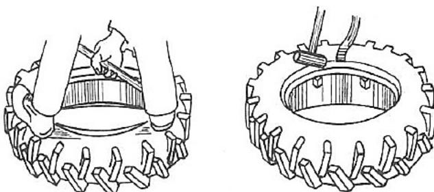
**Рис. 3-7 Монтаж шины.**
