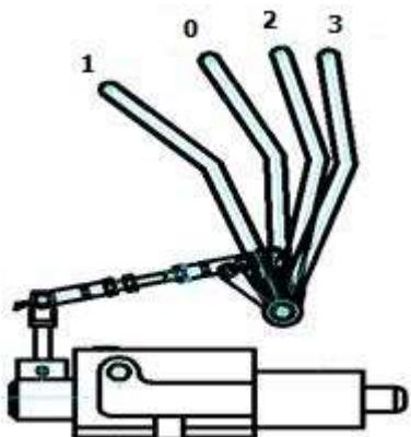
**Рис. 3-9 Механизм управления гидравлического подъемника раздельного исполнения**
