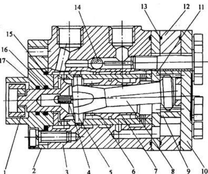
Рис. 5-12 Полностью гидравлический рулевой механизм.
