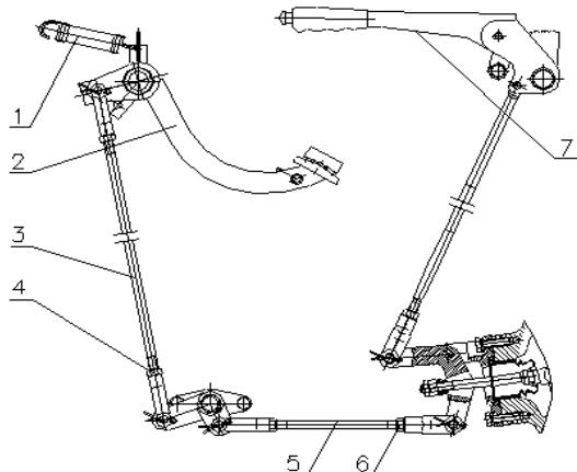
Рис. 5-2 Регулировка тормоза
