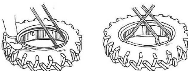
**Рис. 3-6 Демонтаж шины.**
