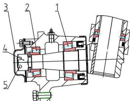
**Рис. 5-6 Регулировка осевого зазора подшипника переднего колеса**
