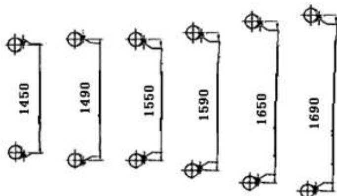
Рис. 3-4 Регулировка задней колеи (мм.)
