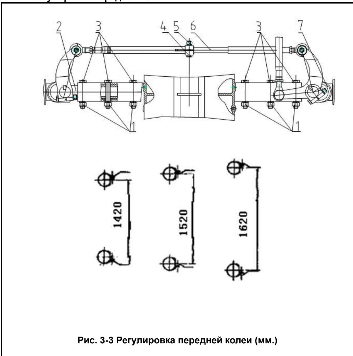
Рис. 3-3 Регулировка передней колеи (мм.)
