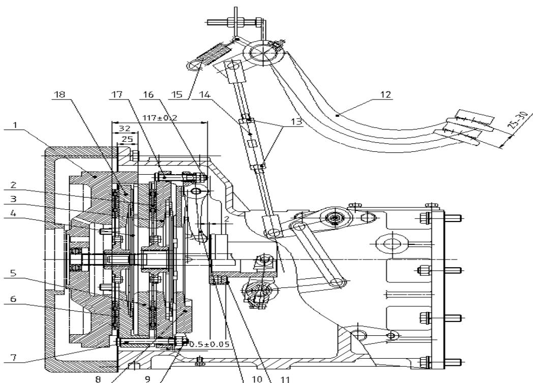
**Рис. 5-1 Регулировка сцепления**
