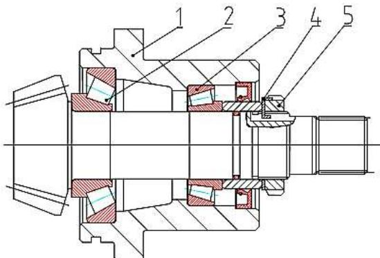
**Рис. 5-9 Регулировка подшипника ведущей конической шестерни переднего центрального привода.**
